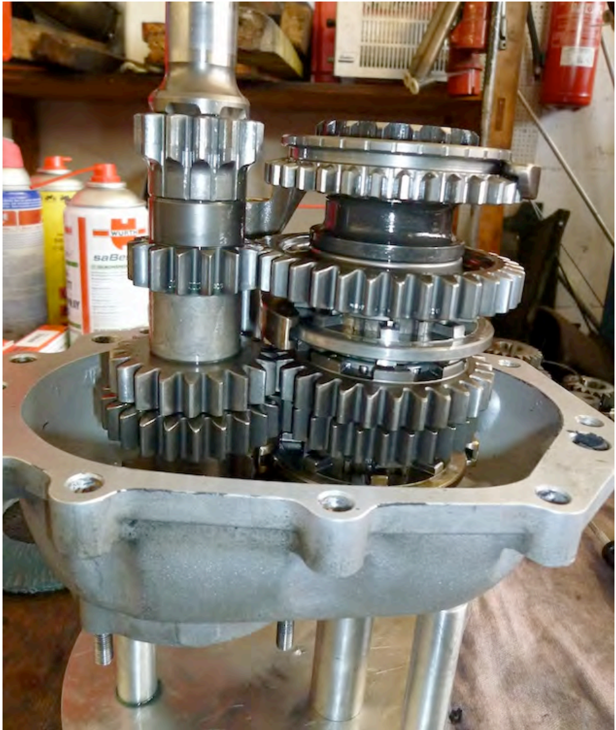
Schalt-(li) und Hauptwelle (re) komplett gesteckt
